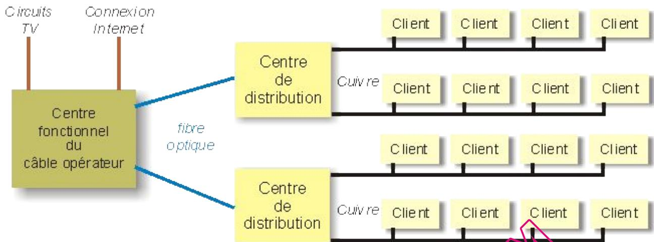
Les clients sont connectés par du cuivre à des centres de distribution, eux-mêmes connectés au centre fonctionnel du câble opérateur par de la fibre optique.
