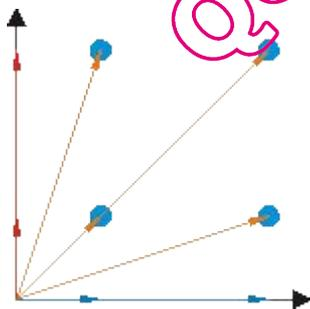
Si l'on reprend l'exemple de la modulation QAM 16, nous aurons par axe, donc par porteuse, deux vecteurs d'argument 0 et de modules représentant le taux de modulation d'amplitude utilisé et deux autres vecteurs de même module, mais d'argument égal à  $180^\circ$ .
