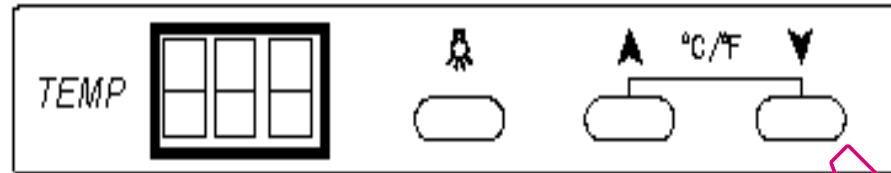
Lorsque l'appareil est allumé, le système de réfrigération commence à fonctionner. La température est réglée dans une fourchette allant de 4°C à 18°C à l'intérieur de la cave.
