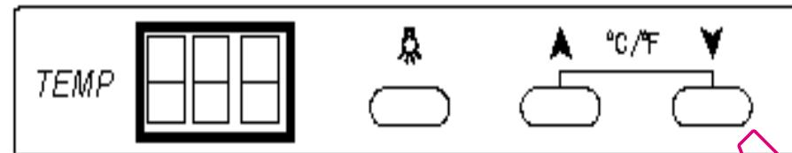
Quando l'apparecchio è acceso, il sistema di refrigerazione comincia a funzionare. La temperatura è regolata in una forchetta che va da 4°C a 18°C all'interno della cantina frigo.
